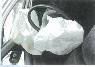
エアバック(電気式)は、安全を確保し展開して 使用済み車両の受け入れ工程 処理しています
