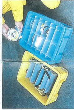
エアバック(機械式)は 単体で取り外され、専 用のケースに入れられ 処理業者へと運ばれ適 正処理されます
